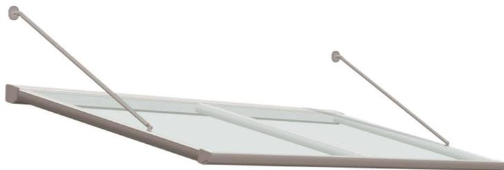
Sistema modulare in alluminio che si contraddistingue per la semplicità di montaggio, da effettuarsi in loco, e per la qualità dei materiali. Grondaia frontale ben integrata nel profilo anteriore per convogliare l'acqua negli appositi scarichi laterali. Verniciatura con polveri poliestere realizzata seguendo rigidi standard qualitativi, copertura in policarbonato da 4 mm. di spessore, tipo ignifugo dassel. Da 85 a 120 cm di sporgenza.
