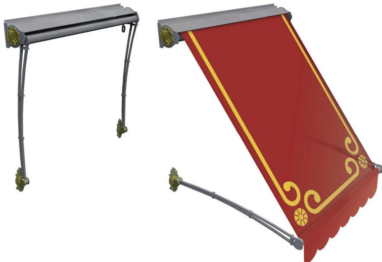
Tenda con bracci rotanti realizzata in ferro battuto forgiato a mano, trattato con zincatura a caldo e verniciato con polveri poliestere secondo rigidi standard qualitativi in tinta grigio ferro micaceo. Tettuccio copritelo in alluminio anch'esso verniciato in tinta grigio ferro micaceo. Telo tinta unita o con decoro. L'eleganza dello stile antico, vuol donare il sapore del passato rivisitato in chiave moderna. Ideale per coprire vetrine e finestre di centri storici o borghi antichi.
